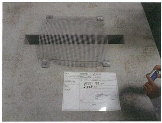
固定間隔 0.5m タテ 試験後
