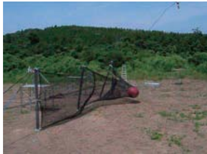
衝撃载荷実験(振り子式)100kJ
