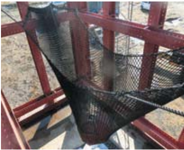
重錘落下実験(自由落下)50kJ
