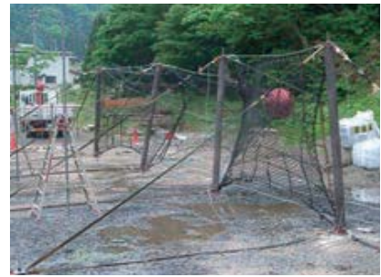
衝撃载荷実験(振り子式)150kJ
