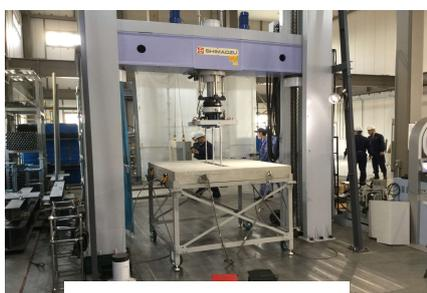
押し抜き強度(載荷試験)
